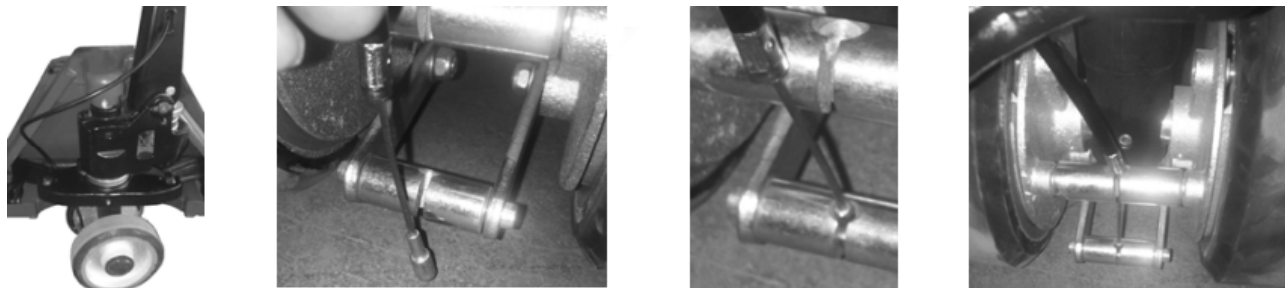
Рис. 9: Установка стояночного тормоза
